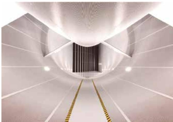
*Sección del difusor de un ventilador de túnel de viento aeroacústico TLT-Turbo*
