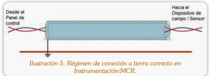
Ilustración 5. Régimen de conexión a tierra correcto en Instrumentación/MCR.
