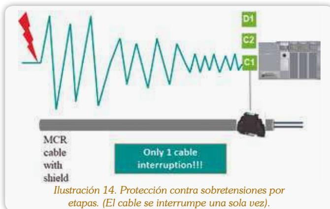
Ilustración 14. Protección contra sobretensiones por etapas. (El cable se interrumpe una sola vez).
